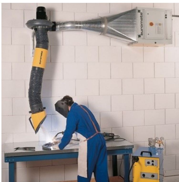
Sistema de extracción de humos y polvo con filtrado (Fuente: www.logismarket.es )
