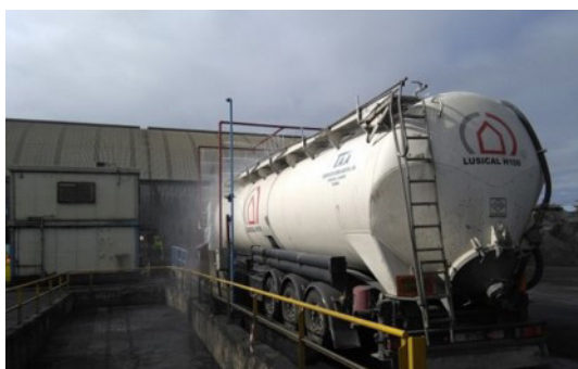
Lavado de camión antes de su salida
